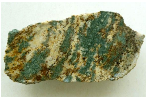
Рис. 2. Характерный облик полосчатой гидротермально-метасоматической породы. Лейкократовая часть представлена агрегатом кварца и кислого плаггиоклаза, меланократовая – магнезиальным амфиболом. Длина образца 10 см.
