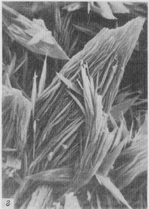
Рис. 3. Лучистые агрегаты тонкопластинчатых кристаллов спертинита РЭМ-фото, увел.: а – 110, б – 1000, в – 450, г – 1000
