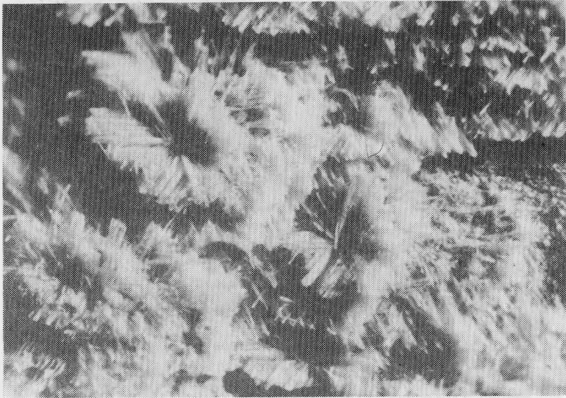
Р и с. 12. Сафенитовые сростания нитяных скелетных кристаллов лютецина под углом \sim 120^\circ друг к другу, выделенные на поверхности гексалитов после протравливания их концентрированной HF. Увел. 40. Урочище Гу-Нус, Северо-Западная Гоби, Монголия
