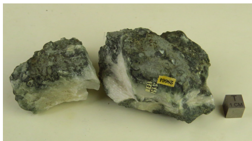
Рис. 21. FMM_1_28664. Записан как натролит, по оптическим и ИК-данным переопределен как томсонит. Н. Тунгуска, утес Кирамки. Отсюда также кальцит FMM_1_28709, 1_28710, FMM_1_28711, FMM_1_28717, FMM_1_28718, барит FMM_1_28709, барит FMM_1_28719, FMM_1_28720, халцедон FMM_1_28685 FMM_1_28686. Костылева указывает, что тут есть также анальцим и прениг.
