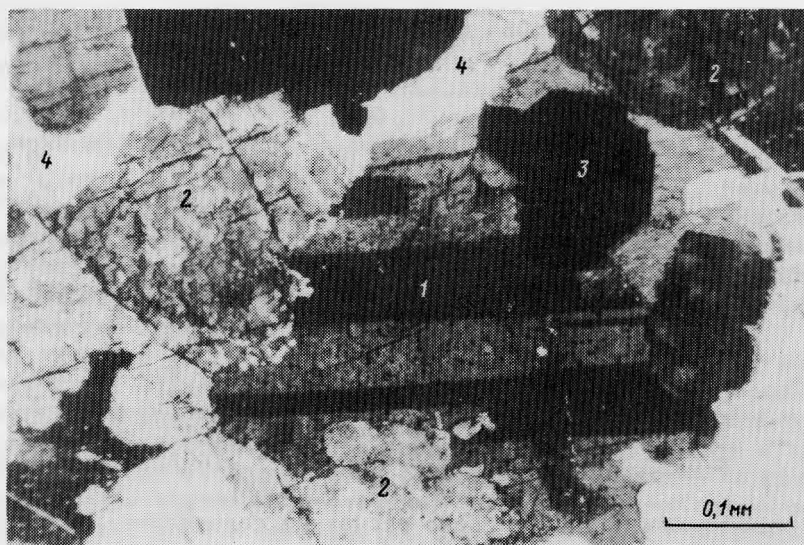
Рис. 2. Сдвойникованное зерно аллеганита (1) в агрегате тефроита (2), спессартина (3), родохрозита (4). Прозрачный шлиф. Николи скрещены
