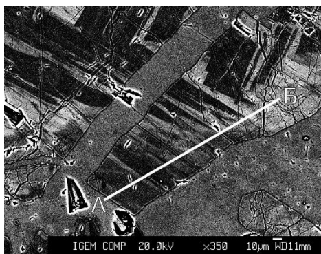
Рис. 7. Фрагмент зонального кристалла V-содержащего дравита; показан профиль АБ (длина 140 микрон), вариации по которому приведены на рис. 8, изображение в режиме обратно-отраженных электронов.
