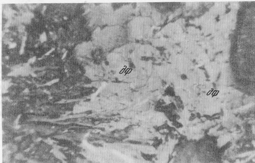
Рис. 2. Замещение диафорита (дф) (сдвойникован) тонконгольчатый агрегатом джемсонита (дж). Аншлиф, с анализатором, увел. 200
