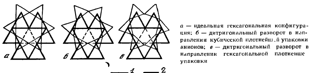
Фиг. 68. Различные конфигурации петли тетраэдрической сетки слюд (1), примыкающей к октаэдрической сетке (2) (по Звягину)
