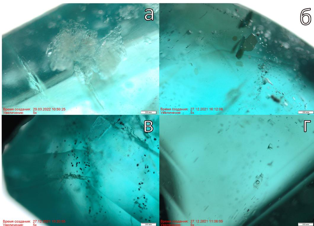
**Рис. 10.** Фото изумрудов в проходящем свете: а – включения доломита, б – включения флогопита, в – включения магнетита, г – газовой-жидкие включения табличатой формы. Масштабная линейка 200 мкм.
