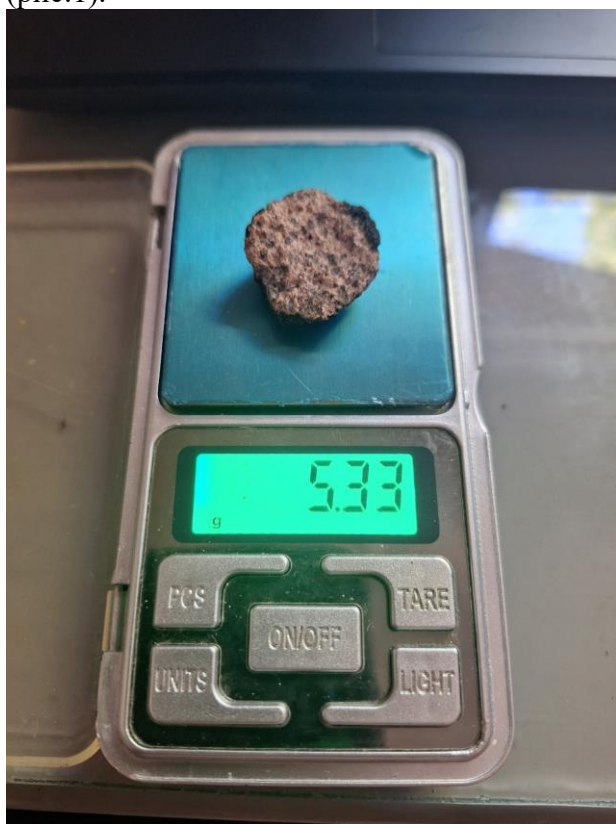
Рис. 1. Фотография фрагмента образца, из которого был изготовлен прозрачно-полированный шлиф.
