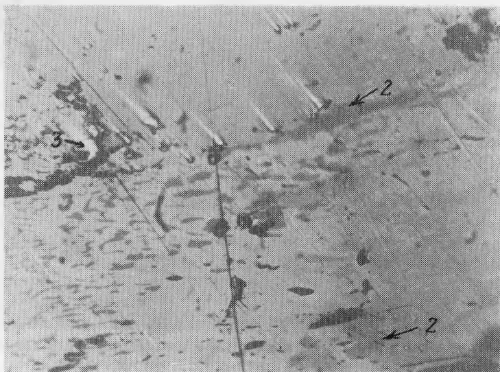
Рис. 3. Распад халькозибита на антимонит (1) и тетраэдрит (2) и бертьерита на антимонит (1) и сурьмянистый пирит (3). Полир. шлиф. увел. 500
