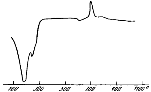
Фиг. 96. Кривая ДТА магадита из шт. Калифорния, США (по Лагали и др.)
