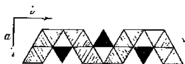
Фиг. 326. Тиллеитовая лента в структуре тиллеита (по Белову) Зачернены группы \text{Si}_2\text{O}_7 .
