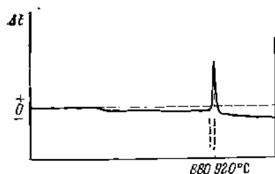
Фиг. 33. Кривая нагревания метамиктного циркона (по Костылевой)
