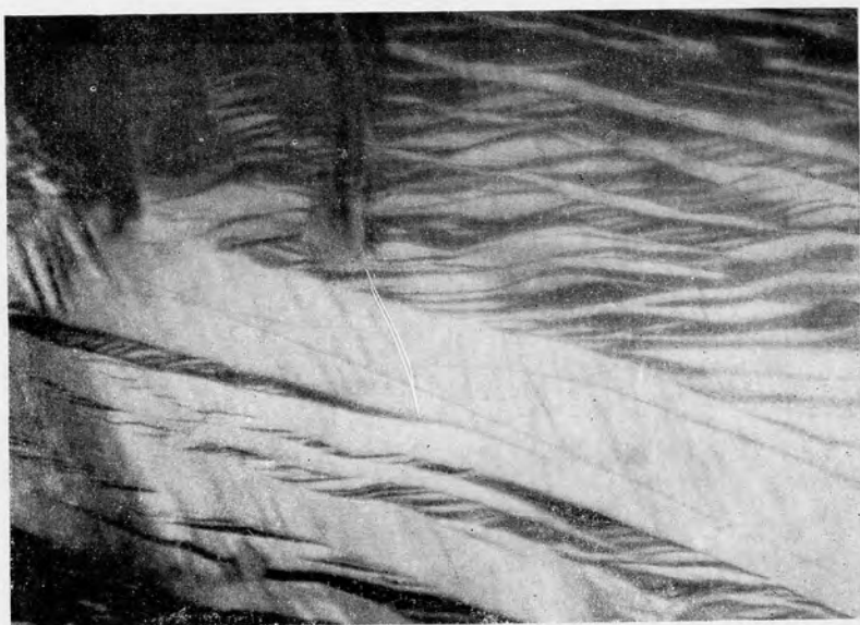
Рис. 2. Сложное двойникование в интенсивно деформированных кристаллах франкеита. Полир. шлиф. Николи+. Увел. 165.
