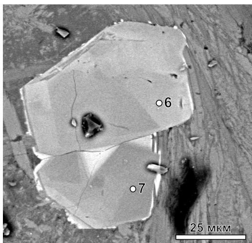
Рис. 5. Биотитсодержащие кварцевые габбронорит-диориты юга интрузива Чамны-Бурун. В гнезде биотита – срастание сложно-секториально-зональных кристаллов REE-эпидота (серый различных оттенков). В верхнем кристалле справа светло-серый сектор (ан. №6, табл. 1). В нижнем кристалле справа серый сектор (ан. №7, табл. 1). На REE-эпидот местами выросла тонкая оторочка метаморфогенного пирита (белый). В отраженных электронах.
