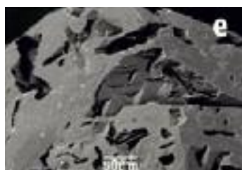
Рис. 7. Сильно дефектный кристалл алмаза № А195. В ЦКЛ хорошо видно сложное строение. Во вторично отраженных электронах видно пористую оболочку: а – общий вид, SE; б – общий вид, фотография в отраженном свете; с – фрагмент поверхности, CCL+SE; д – фрагмент поверхности, SE; е – фрагмент поверхности, SE; ф – фрагмент поверхности, CCL.
