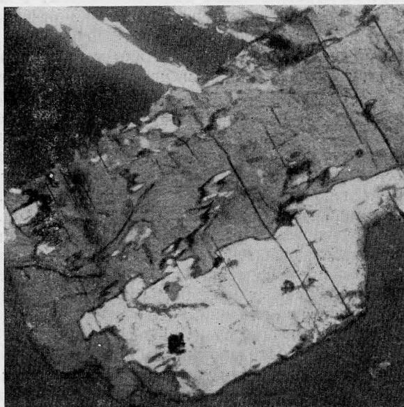
Рис. 6. «Шахматный» тип двойникования в гомогенных калишпатах из пегматита в меланократовых науянтах. Участки с двойниковыми индивидами, имитирующими альбитовые двойники роста. Обр. 376-2, увел. 46, николи +. Разрез  $\perp$  [100]
