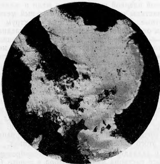
Рис. 3. Зерно палладиевого рожковита с мirmekитоподобной каймой кустелита (ярко-белое). Цементный полированный шлиф. Запрессовано в эпоксидной смоле. Увел. 110
