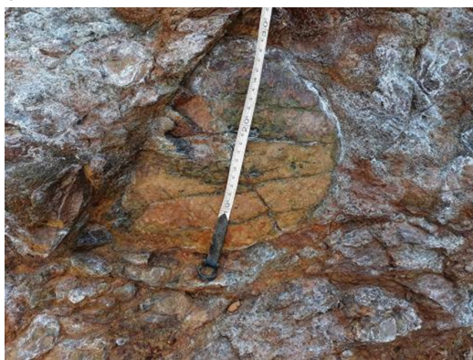
Рис. 3. Коренной выход сульфидных руд на рудопроявлении Хукас и облик слагающих его пород. а, б – общий вид обнажения с Cu-Ni-минерализацией; в – вид рудопроявления после расчистки. Видны многочисленные округлые блоки серпентинитов в силикатно-сульфидных рудах; г – сколотый блок серпентинита 30 см в поперечнике; (Продолжение на следующей странице)
