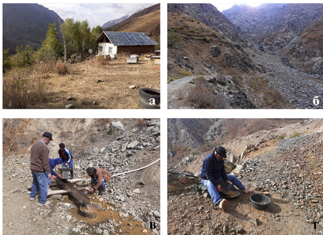
Рис. 1. Медно-никелевое рудопроявление Хукас, Дарвазский хребет, Северный Памир, ГБАО. а – район южного контакта Гишунского массива. Правый борт реки Обихумбоу, напротив впадения ручья Хукас; б – долина ручья Хукас. В центре кадра на правом борту ручья у грунтовой дороги видно обнажение с сульфидными рудами; в – промывка рыхлого материала на шлюзе; г – доводка черногого шлиха, полученного на шлюзе, в лотке.
