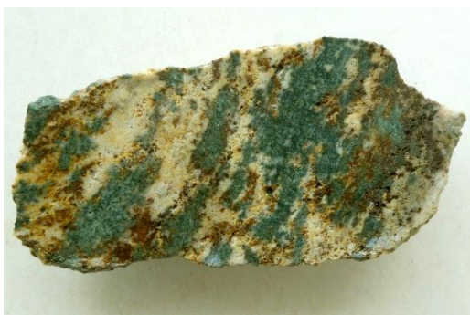
Рис. 2. Характерный облик полосчатой гидротермально-метасоматической породы. Лейкоократовая часть представлена агрегатом кварца и кислого плаггиоклаза, меланократовая – магнезиальным амфиболом. Длина образца 10 см.
